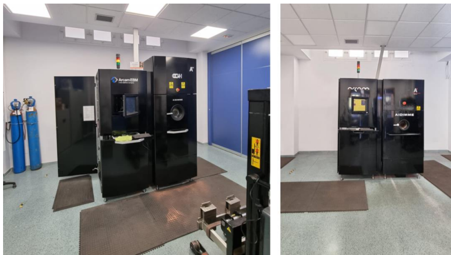
Ilustración 1 Equipos EBM (ARCAM A2X izq, ARCAM A2 dch) en las instalaciones de AIDIMME.
