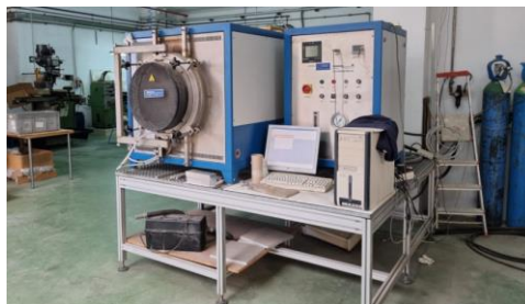
Ilustración 4 Horno para aplicación de tratamientos térmicos en las instalaciones de AIDIMME
